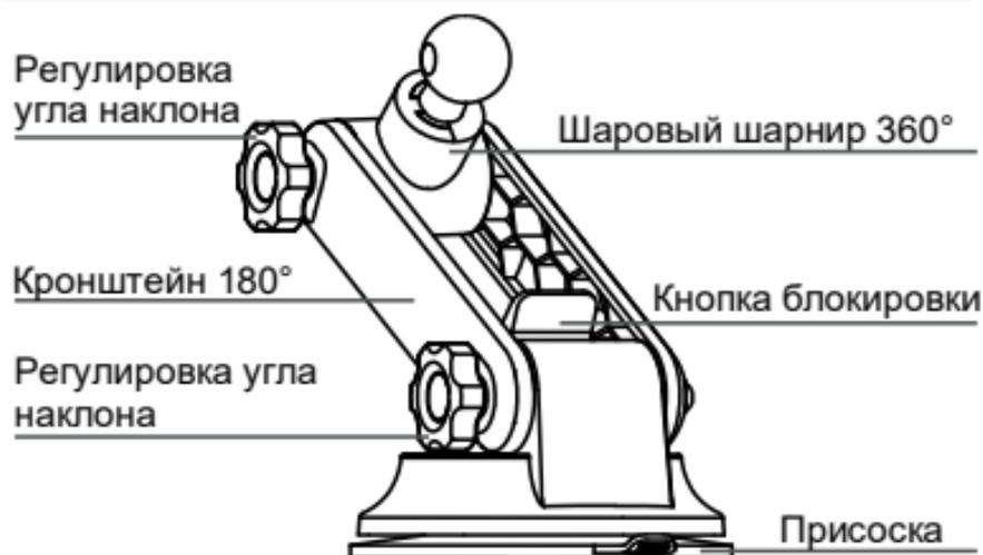
Поместите присоску на подходящее ровное место, отрегулируйте угол и нажмите на кнопку, чтобы прочно зафиксировать присоску на плоской поверхности. После фиксации угол и расстояние между передней и задней сторонами можно регулировать по своему усмотрению.
