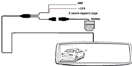
Схема подключения камеры заднего вида
