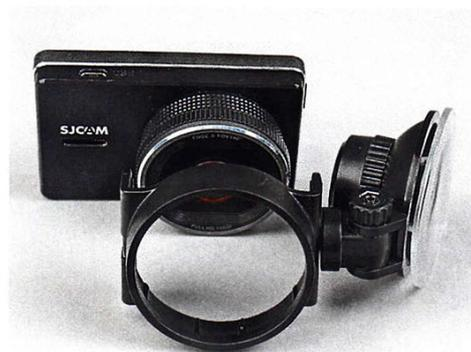
У прибора SJcam SJDash оригинальное крепление – через переходную рамку, в которую просовывается объектив регистратора.
