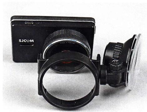
У прибора SJcam SJDash оригинальное крепление – через переходную рамку, в которую просовывается объектив регистратора.
