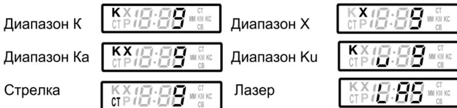
Цифры на дисплее показывают силу улавливаемого сигнала. При отсутствии входящих сигналов и отключенном GPS на дисплее высвечивается информация о выбранном режиме: Н - Highway (Трасса), С - City1 (Город1), мигающая буква С - City2 (Город2).
