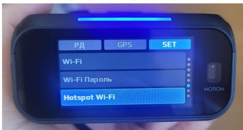
С помощью клавиш ↑ (DIM) или ↓ (MUTE) выбираем нужную цифру и нажимаем √ (MODE), проделываем эту операцию со всеми восьмью символами. После завершения
