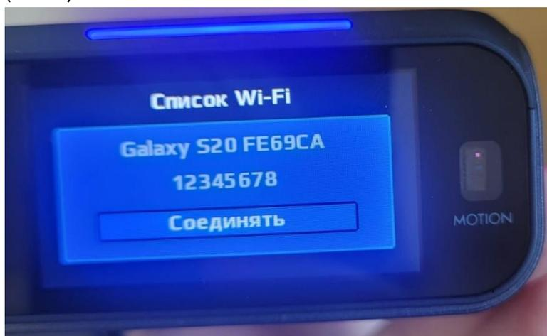
Если в списке сетей ваша сеть отсутствует, выйдите из меню HotSpot с помощью нажатия клавиши X (MENU) в течение 3 секунд, проверьте настройки режима модема и повторите процедуру.
