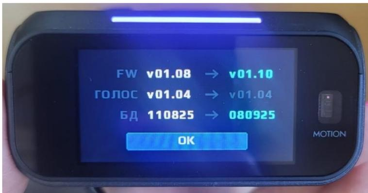
Если устройство не получает доступ в интернет из-за ограничений мобильного оператора, появится окно с надписью «ОТМЕНА». Если доступ в интернет получен, устройство предложит обновиться до актуальных версий ПО, нажмите клавишу V (MODE).
