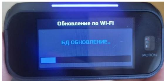
Дождитесь окончания процесса, после чего устройство автоматически перезагрузится. После обновления ПО в случае изменения версии прошивки **необходимо произвести сброс настроек на заводские через меню устройства.**
